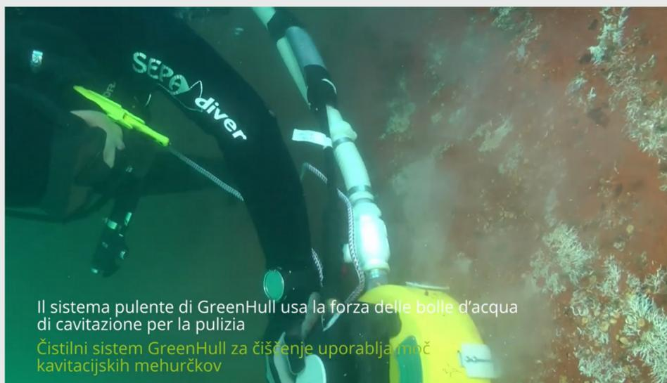
Il sistema pulente di GreenHull usa la forza delle bolle d'acqua di cavitazione per la pulizia
